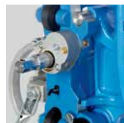
Arbeid uanstrengt og ergonomisk takket være mategir med fin utveksling (i= 1:3,5)
