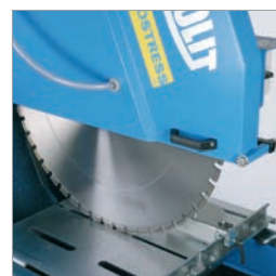
380mm skjæredybde med 1000mm sagblad.
